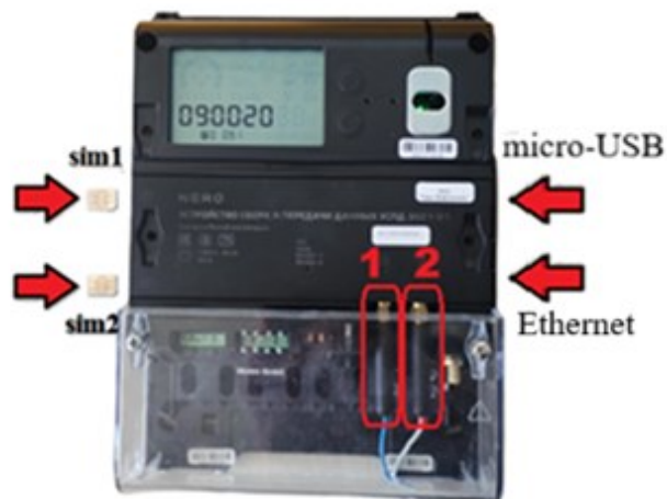
Рисунок 2 – Расположение внешних GSM-антенн УСПД (изображение носит иллюстративный характер)
